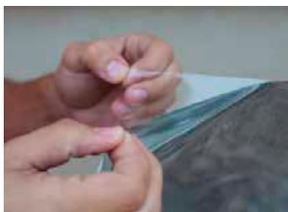
Das Papierklebeband benutzen, um den Liner in einer der oberen Ecken von der Folie zu trennen.
