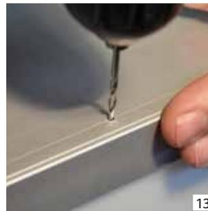
Drücken Sie die „U“-Profile in die Nut und bohren Sie ca. alle 50 cm ein 2,5mm Loch in die dünne V-Nut im Haupt-Rahmenprofil.
