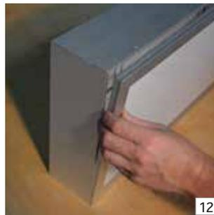
Schieben Sie die komplette Konstruktion in das Haupt-Rahmenprofil – Vorderseite. Legen Sie den kompletten Kasten rückseitig auf einen Tisch / Boden.
