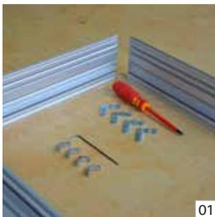
Für die Montage benötigen Sie einen Kreuzschlitz Schraubendreher und einen Inbusschlüssel (2,5 mm ø).
