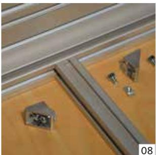
Legen Sie die abgebildeten Teile bereit. Befestigen Sie den Winkel mit Hilfe der Schrauben und Hammermuttern (Hammermuttern nach außen). Diese werden in die dafür vorgesehene Nut gesetzt und mit einem Inbusschlüssel festgezogen. Das Gleiche machen Sie bitte an der Quertraverse. Diese wird, so lange nicht anders bestellt, schmalseitig und mittig in den Rahmen gesetzt.
