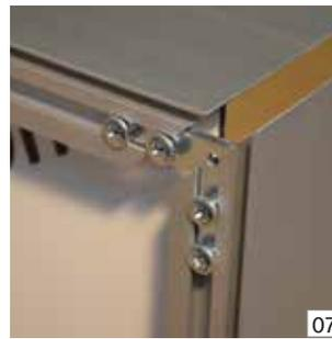
Schrauben Sie alle Winkel in allen Profilecken fest. Der Rahmen ist nun inkl. der Rückwand montiert.
