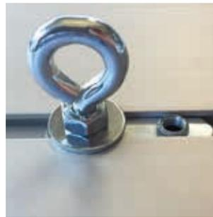
Legen Sie das mitgelieferte Plättchen aus der Verpackungseinheit der Abhängung in die dafür vorgesehene Nut des doppelseitigen Profils ein. Schrauben Sie die Kopfschraube mit der Mutter und Unterlegscheibe von außen darauf.
