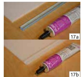
Kleben Sie den mitgelieferten Acrylstab mit der breiten Seite an den oberen Rand der Acrylglasplatte auf die Rückseite. Lassen Sie den Kleber ca. 3-4 Stunden trocknen. Vergessen Sie nicht, die Schutzfolie der Acrylplatte im Bereich der Klebung zu entfernen.
