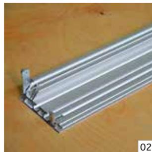
Stecken Sie die großen Eckverbinder (LZD-FF-CORNER-BASIC VE) hinten in die dafür vorgesehene Aufnahme. Stecken Sie die kleineren Winkelverbinder (LZD-FFF-LED-CORNER-INNEN VE) in die passende Aufnahme in Richtung Front in den Rahmen. Machen Sie diesen Arbeitsgang für drei Seiten.
