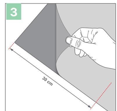
Vergewissern Sie sich, dass die Solarfolie an den Markierungen ausgerichtet ist, und drücken Sie die Ränder der Solarfolie mit der Hand leicht gegen die Montagefläche, um sie in der richtigen Position zu fixieren.
