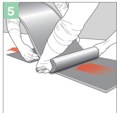
Arbeiten Sie in Richtung der Anschlussdose. Wiederholen Sie Schritt 5, bis der Bereich der Solarfolie um die Anschlussdose erreicht ist.
